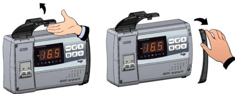
Fig. 1: Løft det gjennomsiktige dekslet som beskytter den motorvern-bryteren og fjern skruen i dekslet på høyre side.
