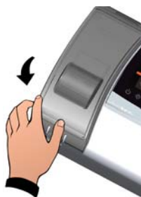
Fig. 3: Lukk det transparente bryterdekselet.
